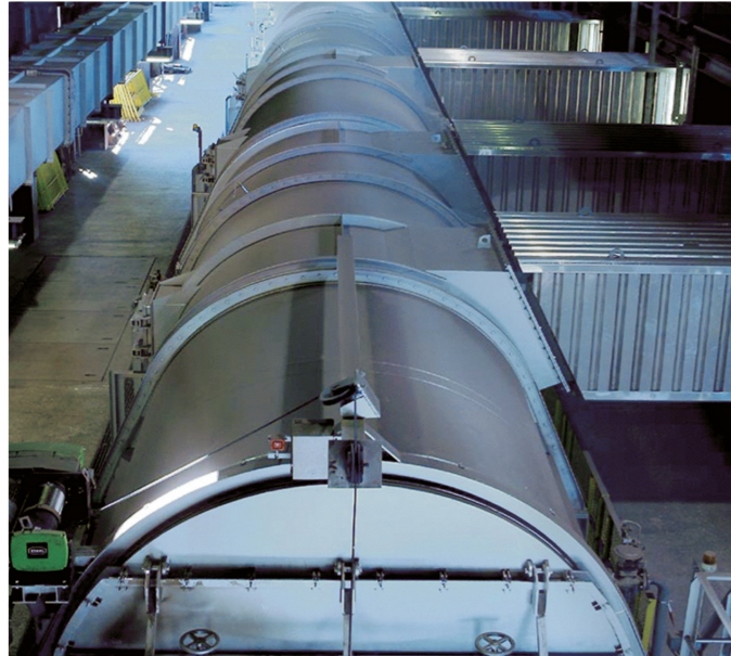
Waste-gas recirculation hood
