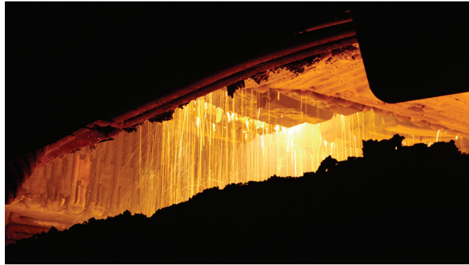
Предварительно нагретый лом на системе удерживающих пальцев
