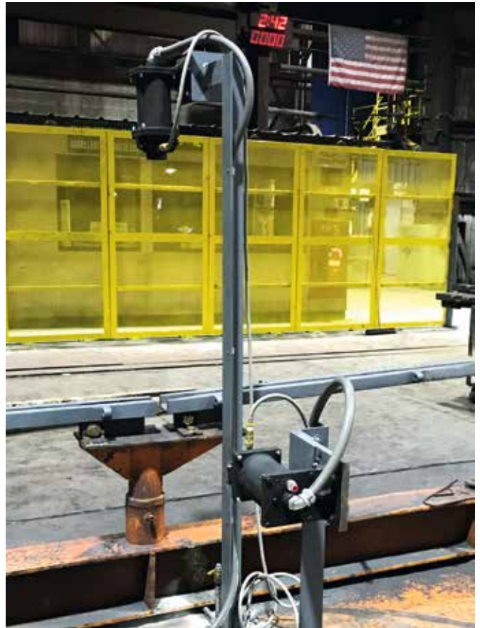
图2：棒材高度测量传感器的布置
