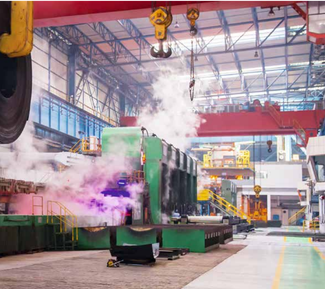
紧凑的工艺总图将连铸机、大压下量轧机和精轧机以及冷却段和卷取段布置在长度仅为180 m的区域内。
