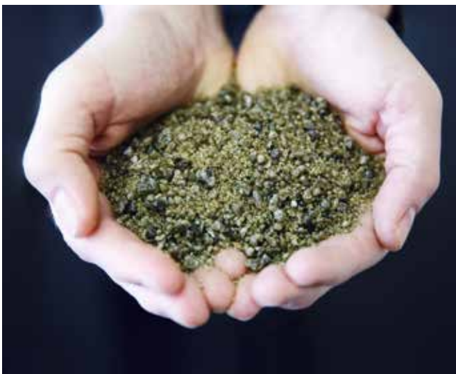
图5：干法渣粒化工艺产生的粒化渣质量极高，玻璃体含量约为94 - 97%。
