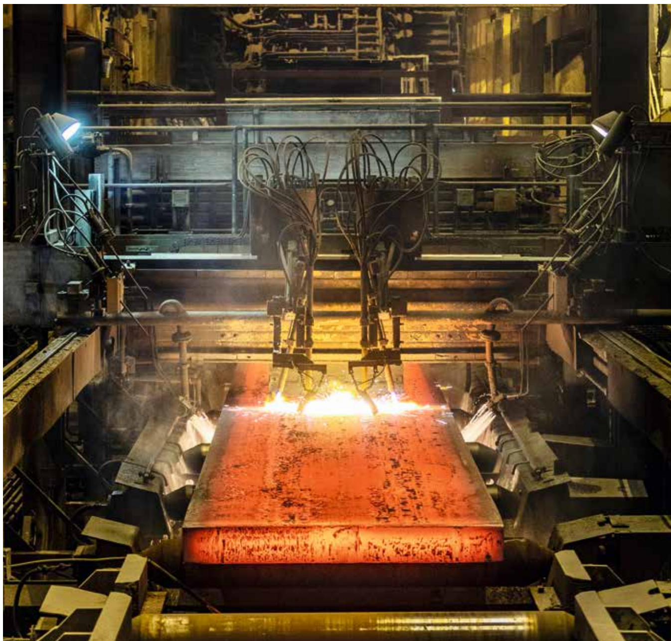
图4: SSAB Raahe(原罗德洛基)厂现在的6号连铸机。就是它在1997年安装了全世界第一套DynaGap Soft Reduction 全动态铸流导向系统。
