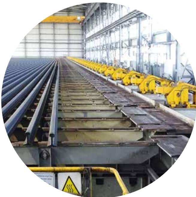
长度为125米的冷床能够容纳120米长的钢轨。
