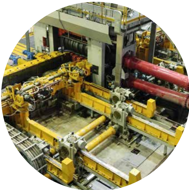
可逆式初轧机采用了刚性牌坊设计，即使施加很大压力也能显著减小机架变形。
