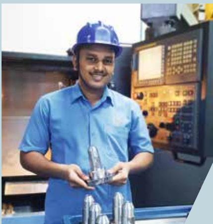
工厂的工人Mahendra Jambhle骄傲地展示他制造的冷却喷嘴插入件，它们将安装在水箱组件上。
