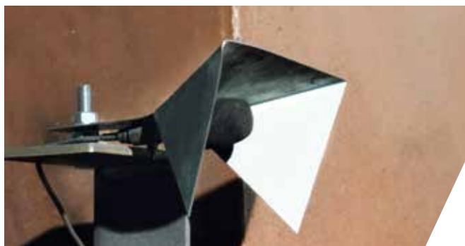
图2: 拾音器的安装位置保证了以最佳效果捕捉到奥钢联钢铁公司的一个弛张筛发出的声音。
