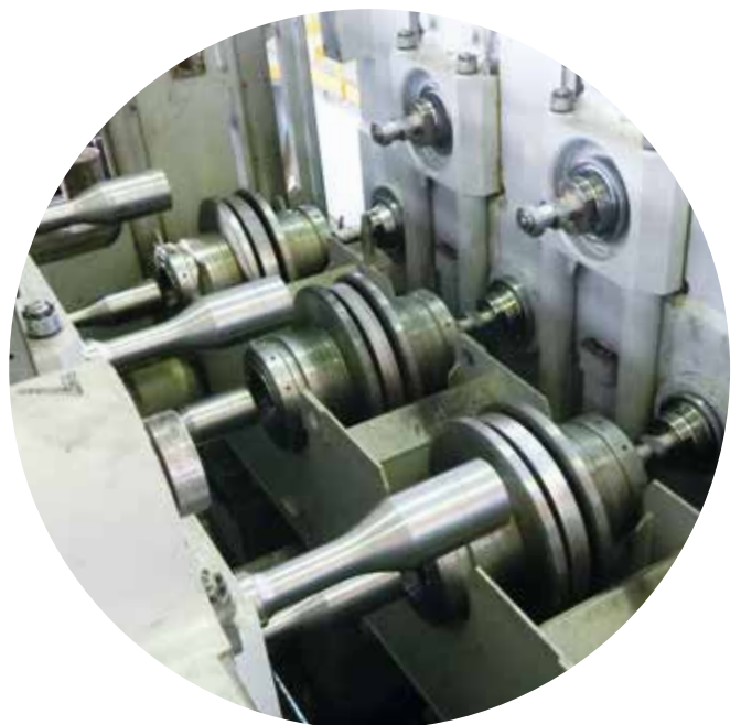
钢轨水平矫直机能够以每秒2米的速度对轨头和轨底进行矫直。
