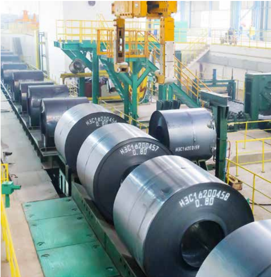
中国日钢阿维迪ESP线生产的0.8 mm薄规格带卷。公司拥有5条ESP生产线。
