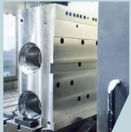
这种弯辊块在一开始只是一大块金属，制造团队将其“雕刻”成最终产品。
