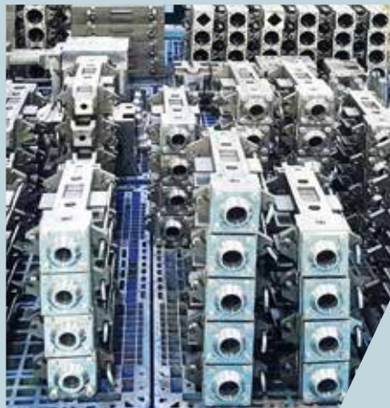
Turbhe制造厂每年制造大约5,000 - 6,000个这种水箱喷嘴，其中的大部分都发给海外客户。
