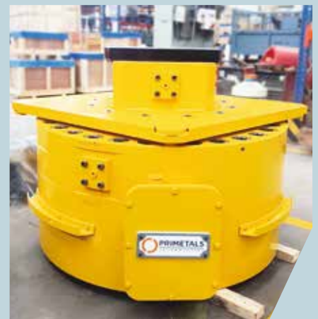
最近完成修复的这台HAGC油缸让制造团队非常骄傲。现场有一个测试台。
