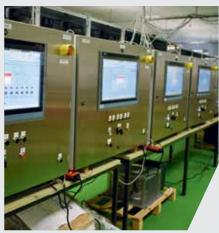
测试中心的作用是在新自动化设备发往钢厂之前对其进行测试。这些是精轧机换辊操作用控制
