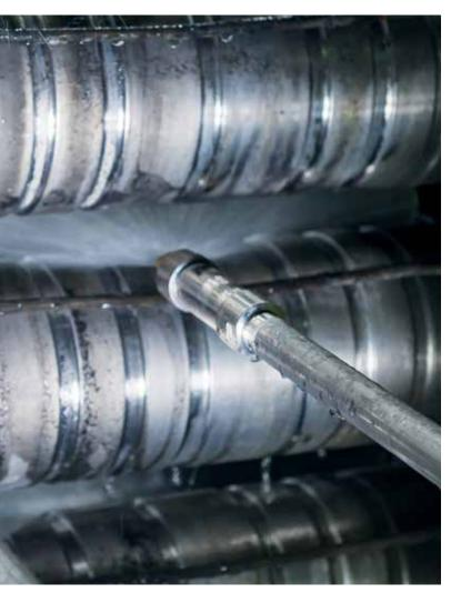
增加的空气仪表和自动化可以在铸机运行过程中安装。换下的弯曲段或扇形段可以在进行维修前改成使用DynaJet Flex喷嘴,经过离线测试后在维修时安装到铸机上。空气管路与弯曲段或扇形段之间的连接通过多个快速接头实现,从而能够在开始浇铸时就启用DynaJet Flex冷却系统。事实上,采用DynaJet Flex系统对那些没有划分中心-边缘冷却区的铸机进行升级,能够节省大量的时间和费用。
