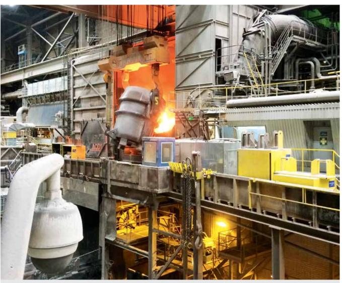
奥托昆普Tornio厂改造后的1号AOD转炉成功恢复运行。普锐特冶金技术为该转炉安装了新的倾动传动、托圈和其他相关设备(含电气和自动化设备)。
