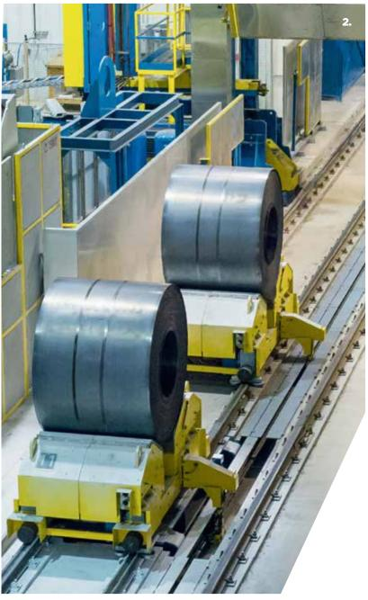
普锐特冶金技术开发了一种创新性的模块式带卷运输系统,采用了沿专用轨道移动的远程控制自驱式运输车。奥地利专家负责所有设计和制造工作以及相关电气和自动化。运输车自带电机,由一套与现有工厂自动化完美集成的自动化系统进行控制,能够实现带卷运输系统、厂房天车和所有相关带卷处理站之间的优化协调。
