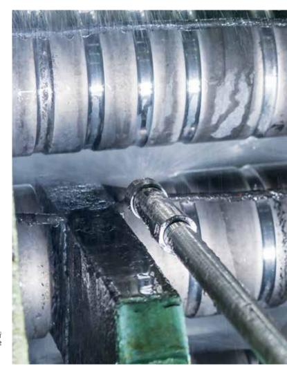
**图3:** DynaJet Flex喷嘴正在运行中。这是韩国现代钢铁公司唐津厂安装的系统。
