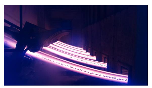
普锐特冶金技术对俄罗斯南部 Krasnodar 地区 Abinsk 电炉钢公司短流程钢厂的电弧炉、钢包炉和 6 流小方坯连铸机进行了现代化改造。上图是普锐特冶金技术提供的一台 6 流小方坯连铸机。
