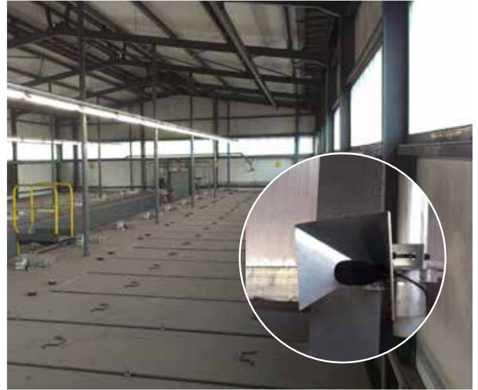
バグフィルタの上部ハウジングおよび工業用マイクロフォン
