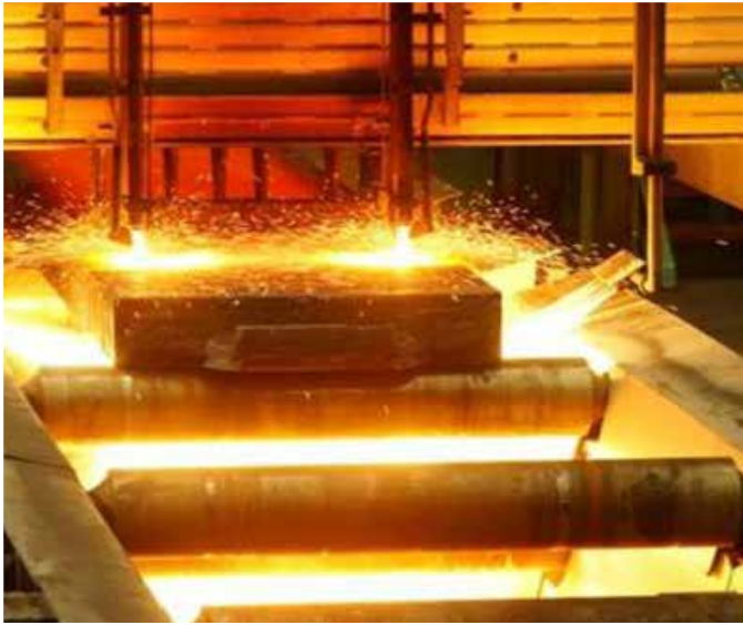
連続機用トーチカッター向け音響診断
