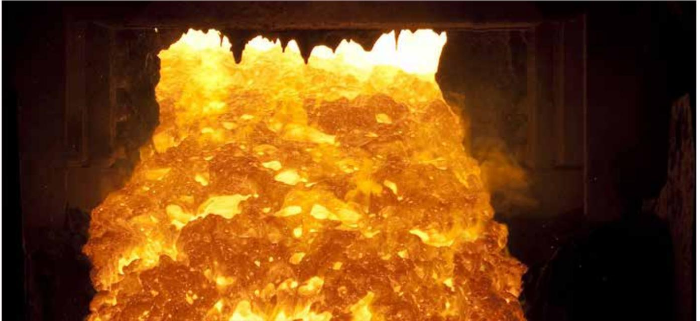
Slag door with foaming slag
