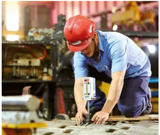
普锐特冶金技术服务专家正在使用公司开发的光学测量工具Opal系统检查铸流导向辊的对中情况。
