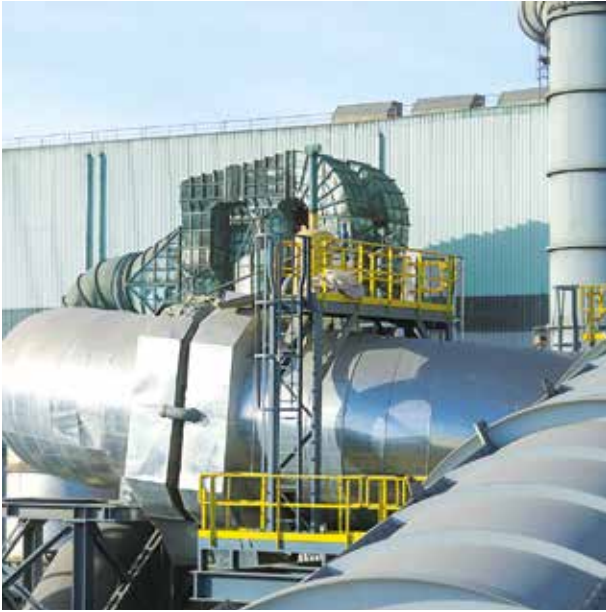
意大利Cremona阿维迪公司电弧炉废热回收产生蒸汽系统的工业应用
