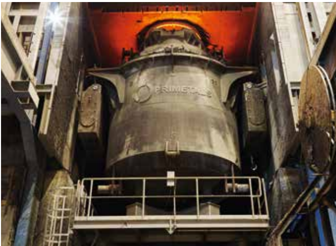
SIJ Acroni厂炼钢车间的新建95吨AOD转炉
