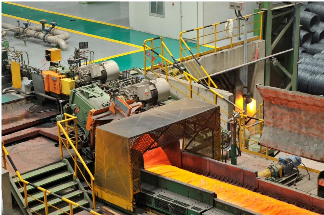
中天鋼鉄のピンチロールとレイングヘッド。Primetals Technologies は中天鋼鉄のワイヤーロッドミル 2 台を更新予定。
