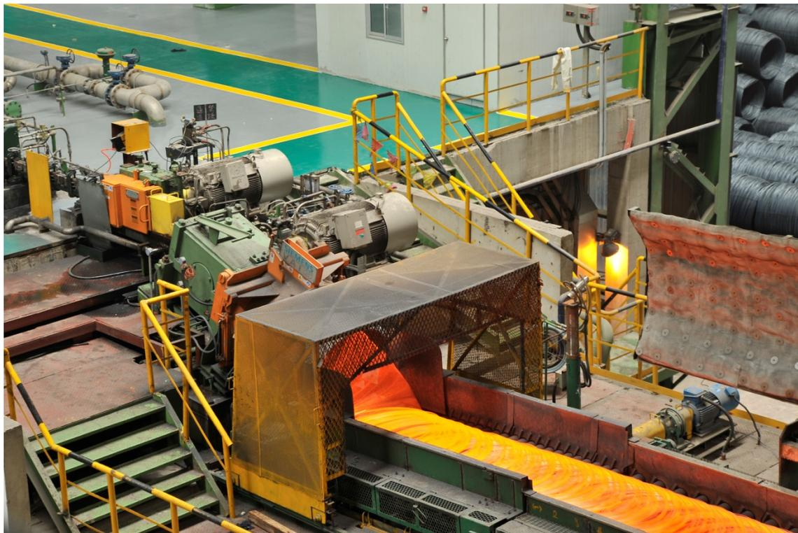
Трайб-аппарат и виткоукладчик на заводе Zenith Steel. Primetals Technologies реконструирует два мелкосортных стана для Zenith Steel, Чанчжоу, Китай.
