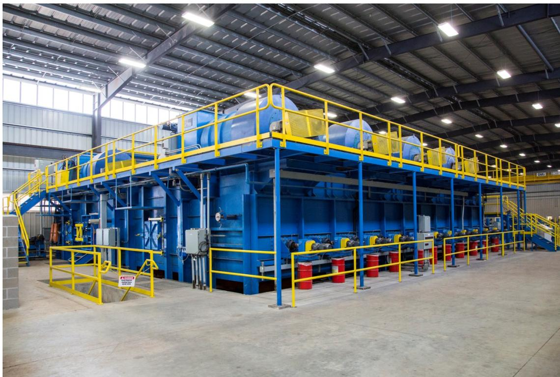
Das neue Stahlwerk von Borusan in Baytown, Texas, USA, wird Rohre und Leitungen für die wachsende Öl- und Gasindustrie produzieren. Primetals Technologies lieferte dafür die Wärmebehandlungsanlage.
