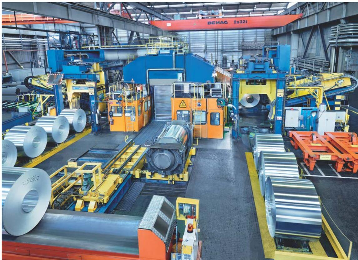
Produção de chapas na AMAG rolling GmbH em Ranshofen, Austria. A Primetals Technologies está modernizando toda a tecnologia de drives do laminador a quente quadro-reversível (foto: AMAG rolling GmbH)
