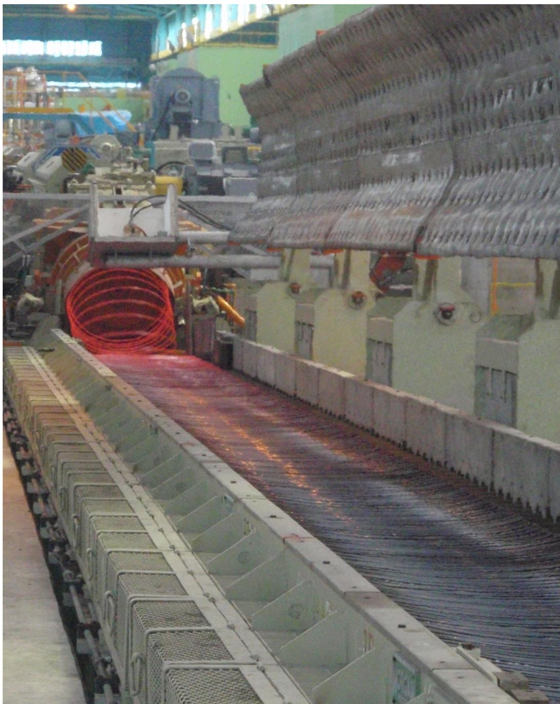
喷嘴安装板下方采用普锐特冶金技术Optimesh系统的摩根Stelmor冷却运输线。
