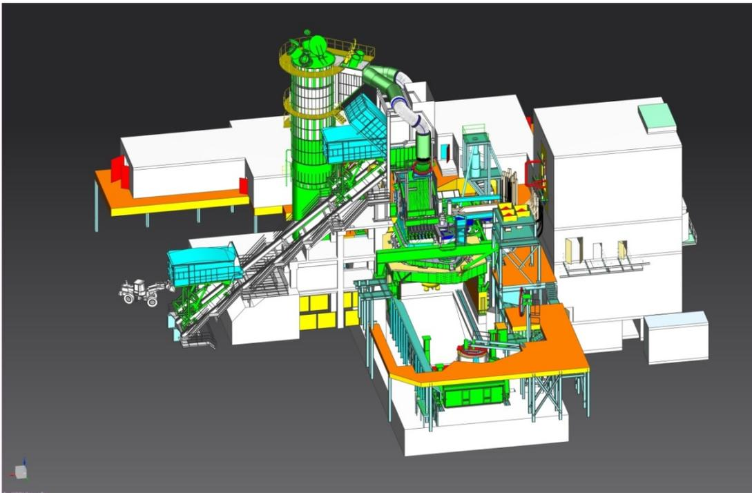
普锐特冶金技术EAF Quantum炉的计算机模拟图。位于意大利克雷莫纳的Acciaieria Arvedi公司将安装这种电弧炉。
