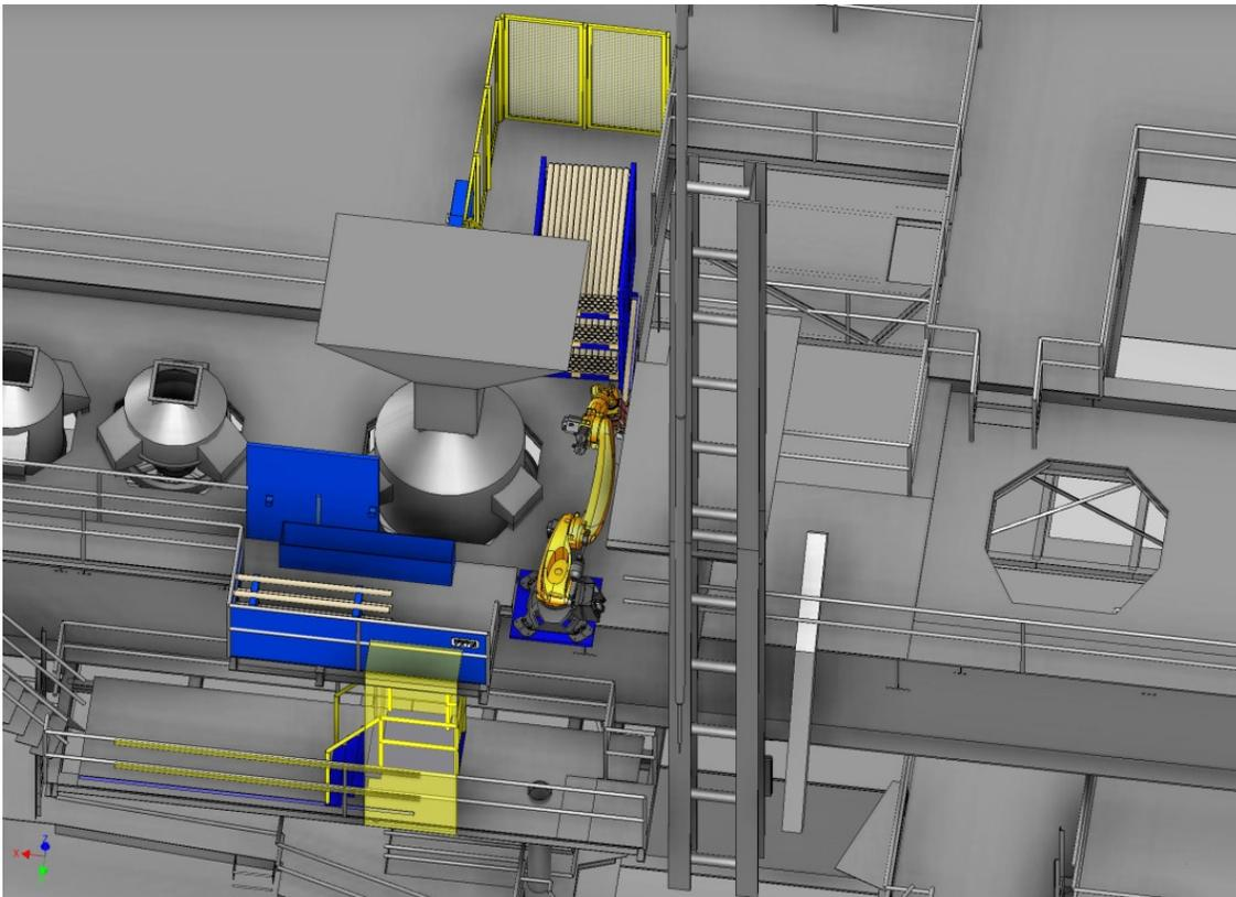
普锐特冶金技术提供的机器人系统将在奥地利林茨奥钢联钢铁公司欧洲钢厂的3座LD (BOF) 转炉上执行探头操作。
