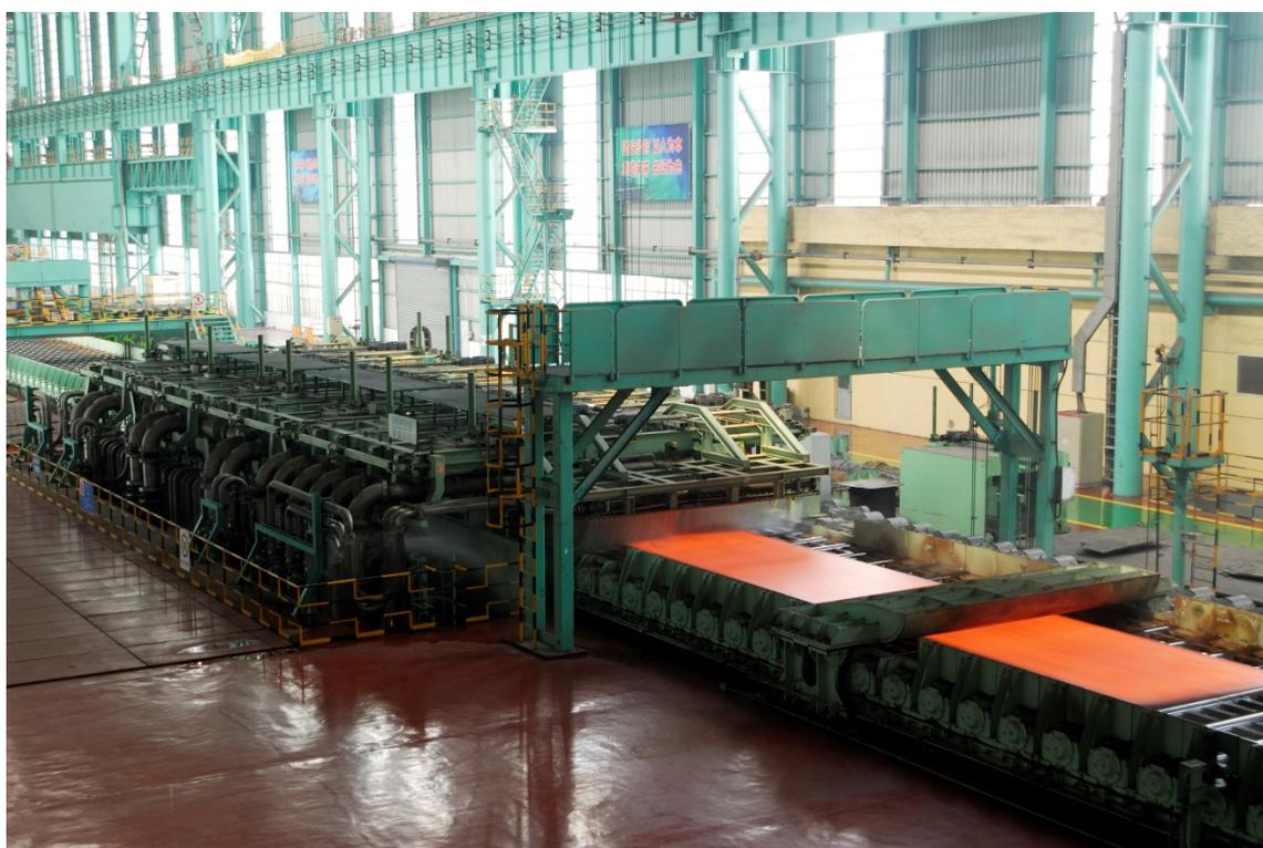
Primetals Technologies 製の Mulpic (Multi-Purpose Interrupted Cooling) システム
