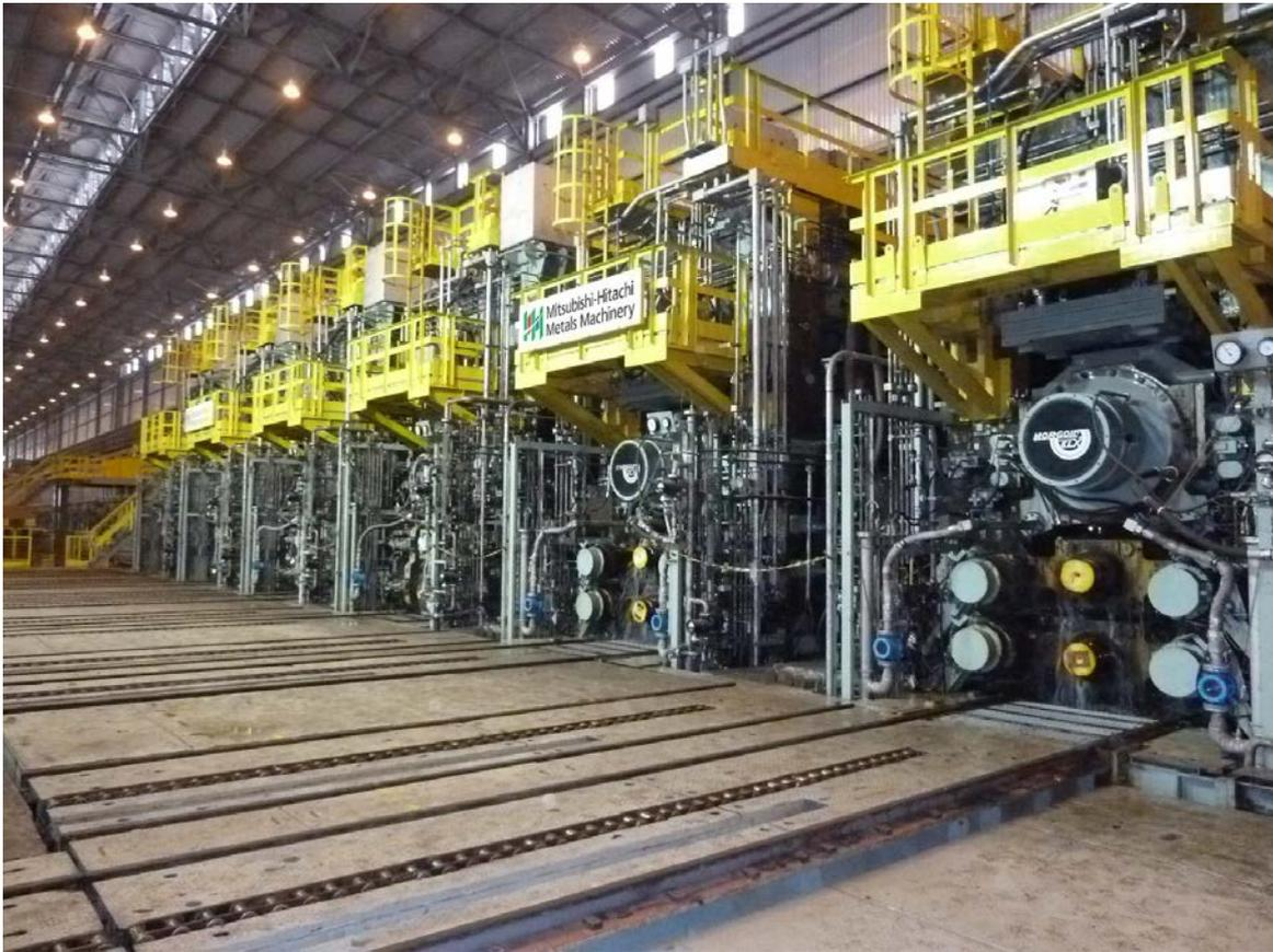
ペアクロス技術が装備された当社の熱間圧延設備の仕上げ圧延機。
