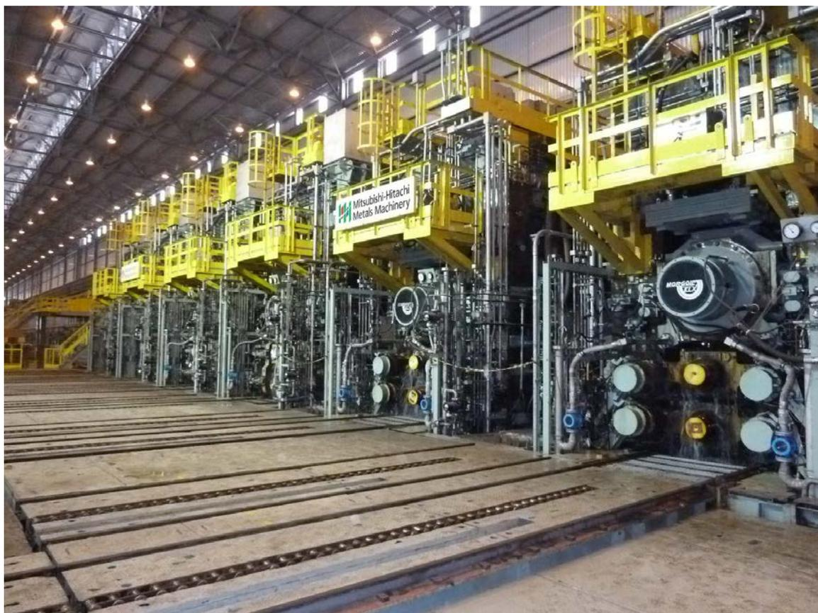
普锐特冶金技术提供的一套热轧带钢机的精轧机组。这些机架采用了双交叉技术，优化了带钢的凸度控制。
