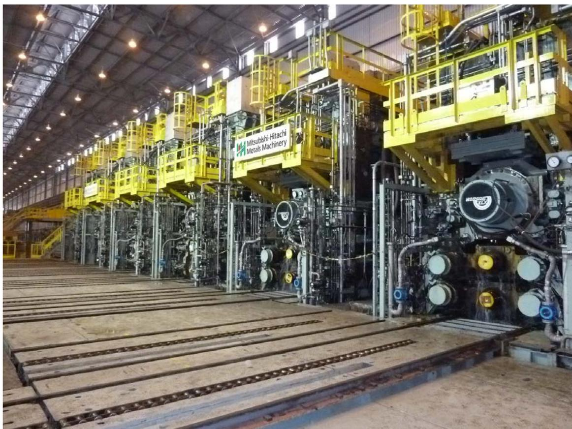
Fertigstraße eines Warmwalzwerks von Primetals Technologies. Die Gerüste sind mit Pair-Cross-Technologie zur optimalen Profilsteuerung ausgestattet.
