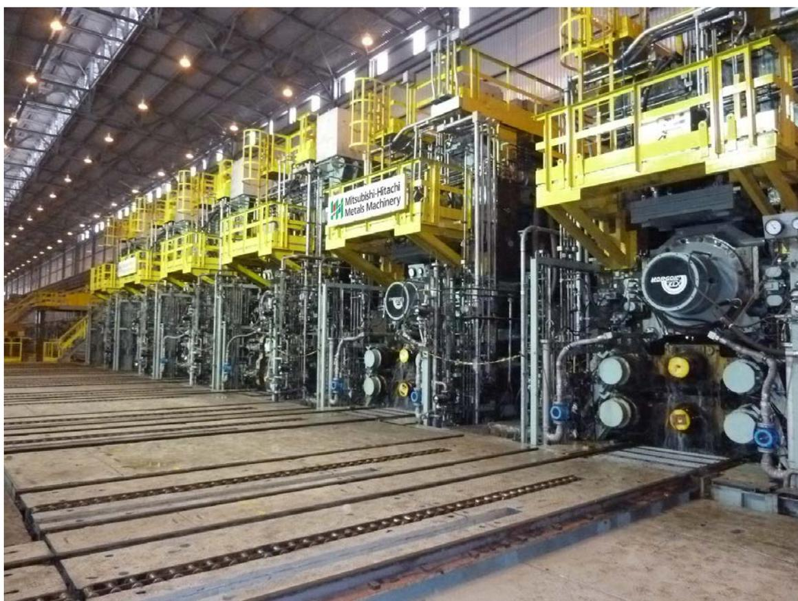
Trem acabador de um laminador de tiras a quente operado pela Primetals Technologies. As cadeiras são equipadas com tecnologia de cilindros em par cruzado para controle otimizado do perfil.
