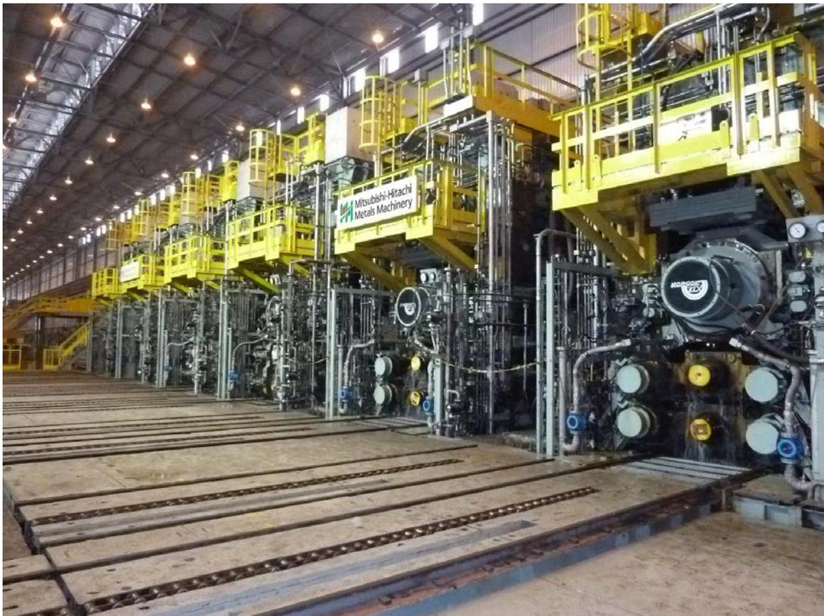
Линия чистовой группы стана горячей прокатки компании Primetals Technologies. Клетки прокатного стана оснащены технологией «pair cross» для достижения оптимального контроля за профилем полосы.
