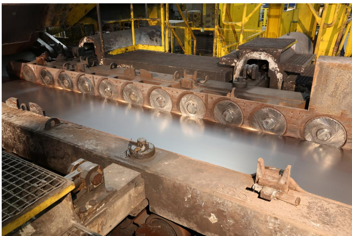
Eco Slide Disc の設置された熱間圧延機ダウンコイラー入側のサイドガイド。
