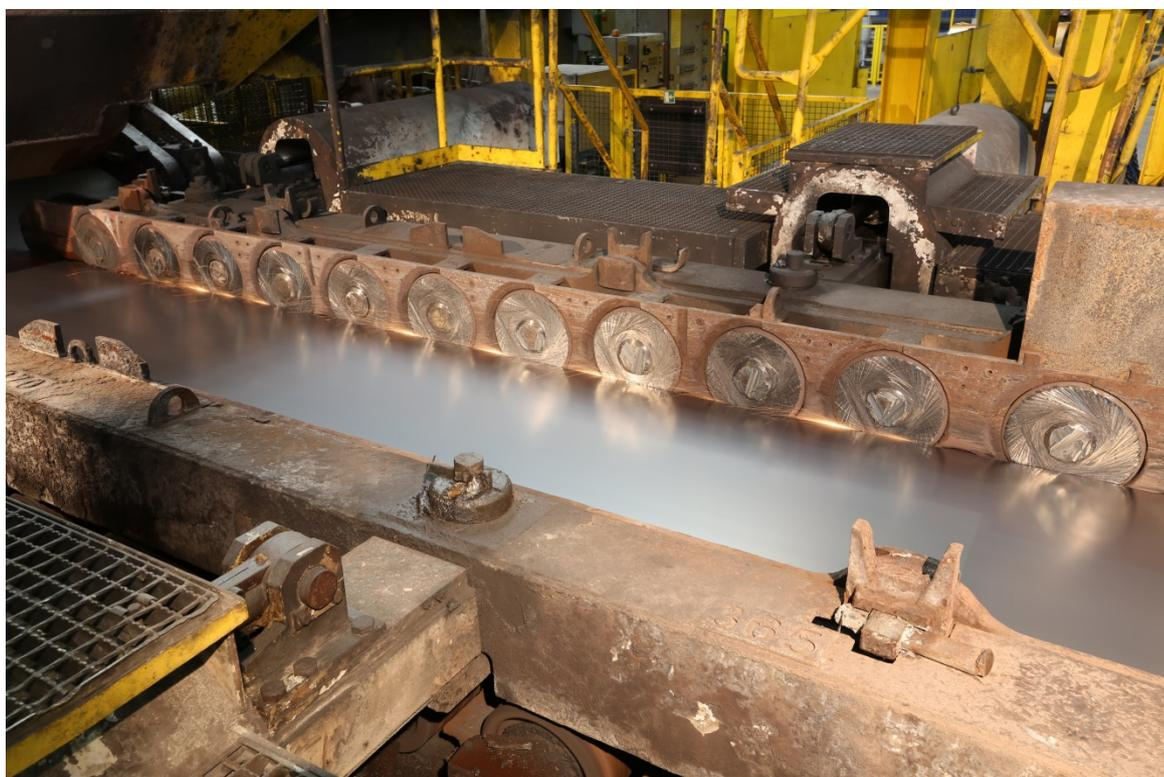
Guias laterais com os Eco Slide Discs da Primetals Technologies no lado de entrada da bobinadeira no laminador de tiras a quente da voestalpine Stahl em Linz, Austria..
