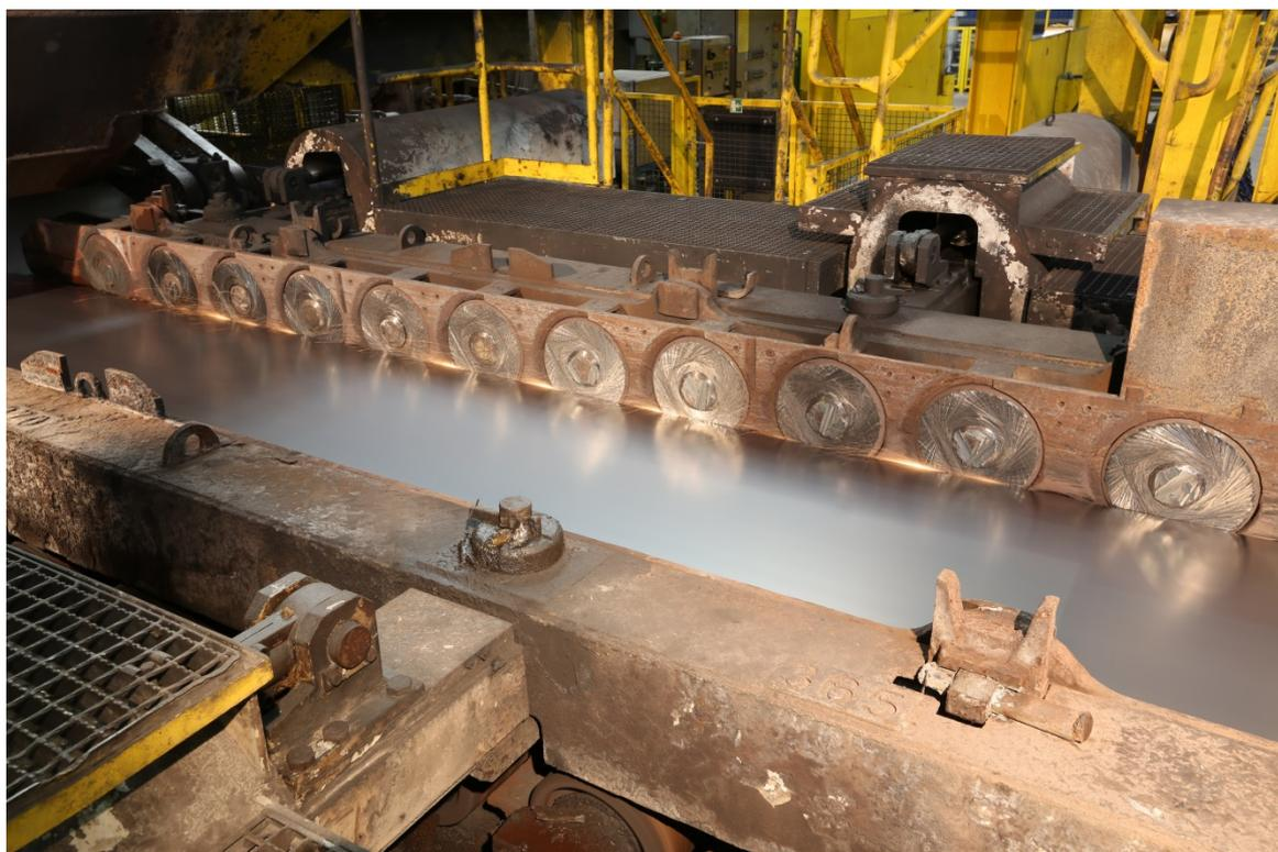
Боковые направляющие с дисками "Eco Slide" от компании Primetals Technologies на входной части подпольной моталки стана горячей прокатки полосы компании voestalpine Stahl в городе Линц, Австрия.
