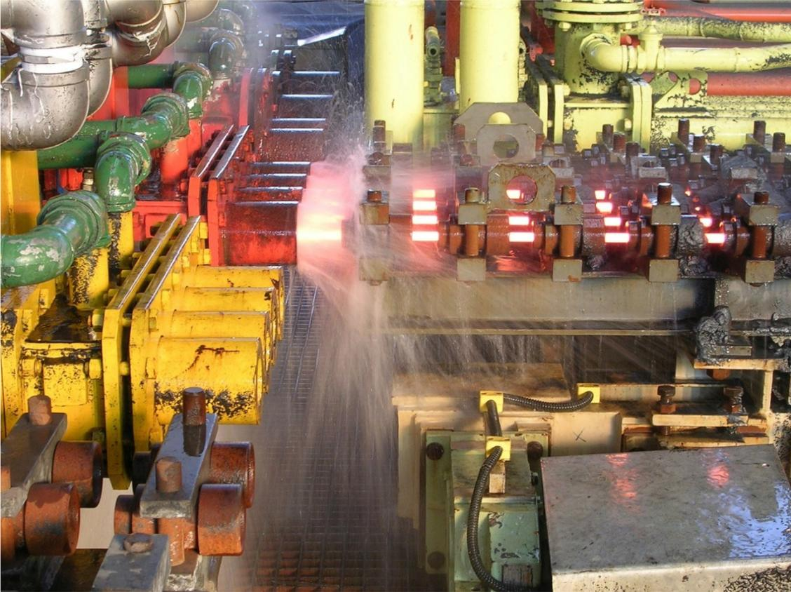
普锐特冶金技术提供的一套棒材轧机中的 PQS 热处理系统，轧机采用多切分模式
