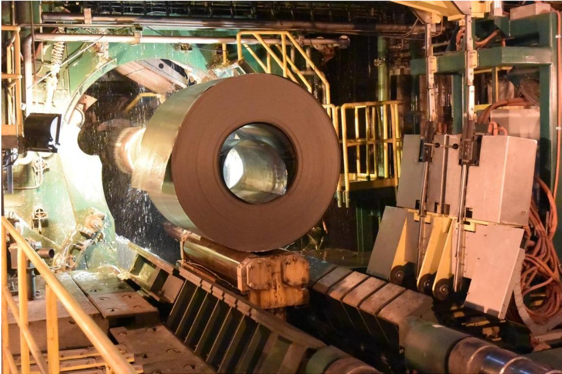
Arvedi-ESP-Anlage Nr. 1 bei der Rizhao Steel Group Co., Ltd in Rizhao, China. Im Juli, produzierte die von Primetals Technologies gelieferte Anlage ultra-dünnes Warmband mit einer Dicke von 0,8 Millimetern.
