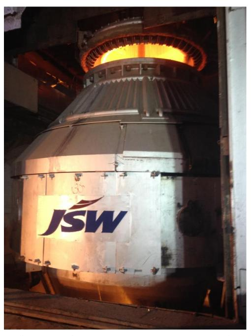
普锐特冶金技术为印度 JSW 钢铁 Toranagallu Vijayanagar 钢厂第二炼钢车间提供的 LD(BOF)转炉。
