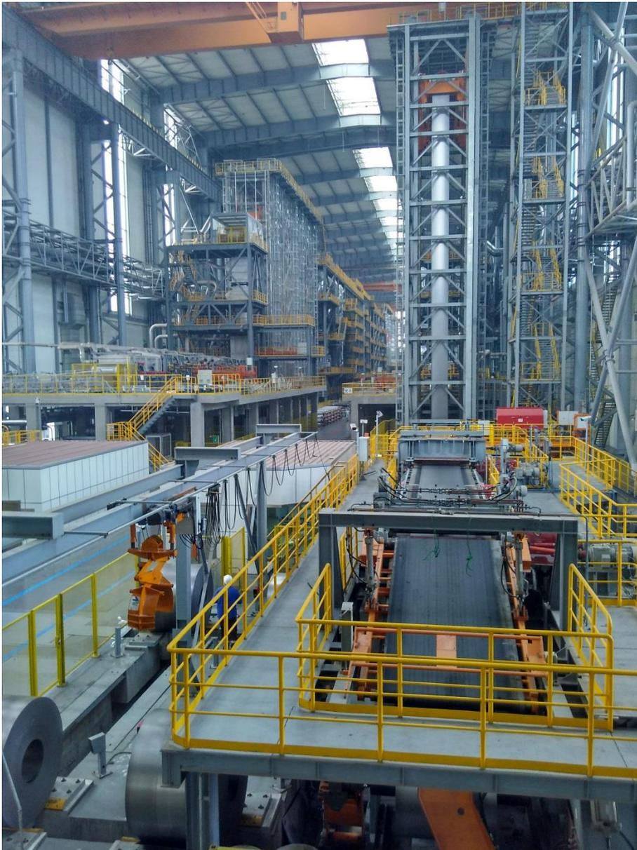
Существующая линия цинкования, поставленная компанией Primetals Technologies для стана холодной прокатки на предприятии Tangshan Iron and Steel Group Co. Ltd. Данная компания заказала еще две линии.
