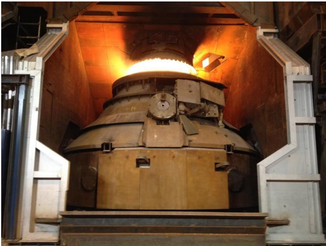
普锐特冶金技术为 SSAB 欧洲钢铁公司芬兰拉赫钢厂提供的 LD (BOF) 转炉
