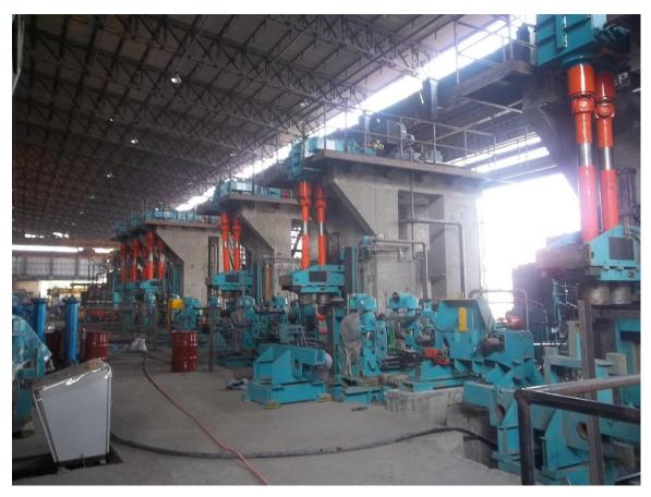
普锐特冶金技术为印度钢铁企业 Kalika 钢合金私营有限公司(Kalika 钢公司)马哈拉施特拉邦贾尔纳工厂提供的螺纹钢生产线
