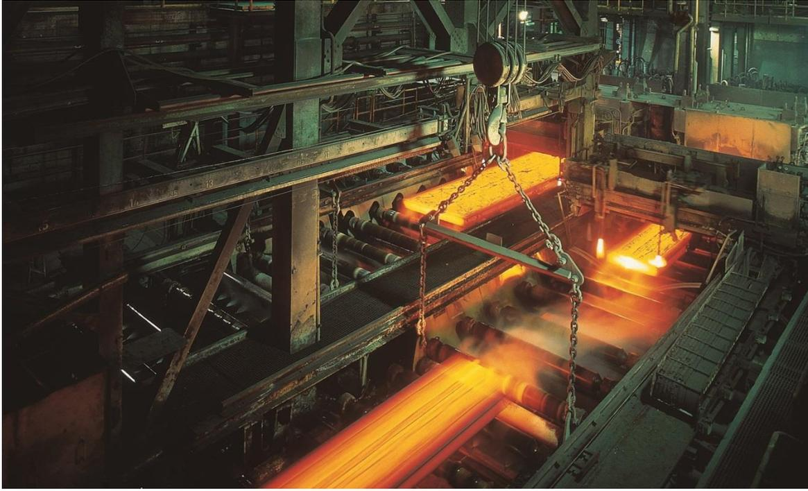
普锐特冶金技术为德国钢铁企业安赛乐米塔尔不来梅有限责任公司改造的板坯连铸机（版权归安赛乐米塔尔不来梅有限责任公司所有）
