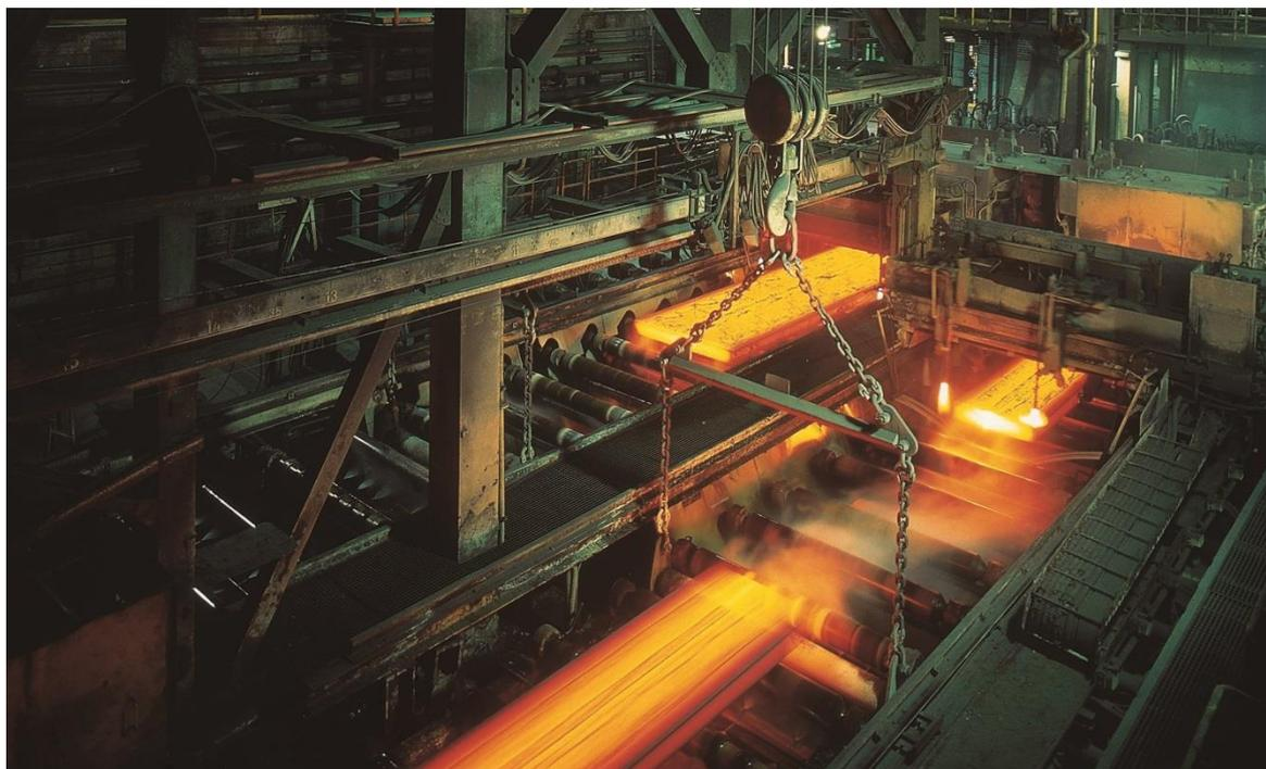
Primetals Technologies により近代化されたドイツアルセロールミットル・ブレーメンの2ストランド方式連続スラブ鋳造機（著作権:ArcelorMittal Bremen GmbH）
