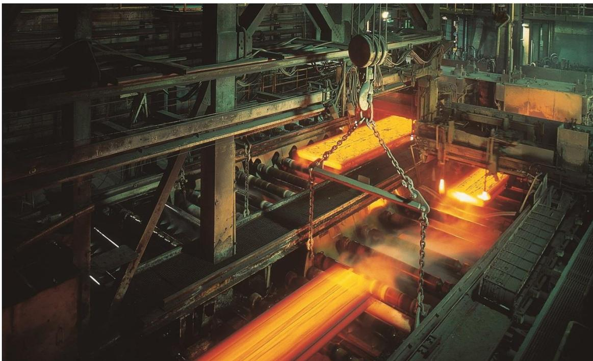
Двухручьевая слябовая МНЛЗ, модернизированная компанией Primetals Technologies, на предприятии немецкого производителя стали ArcelorMittal Bremen GmbH
