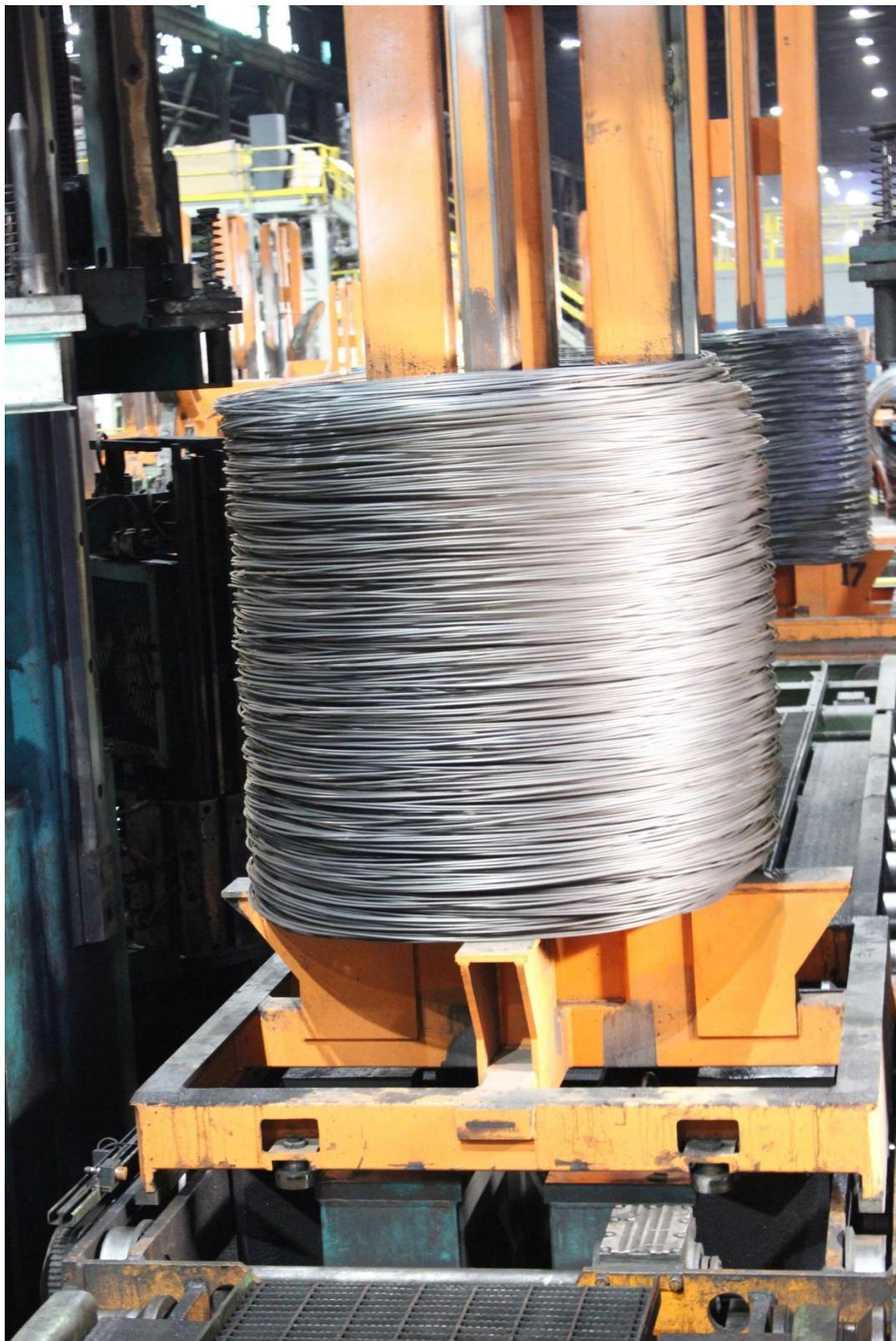
Palettensystem mit vertikalem Bundhalter von Primetals Technologies
