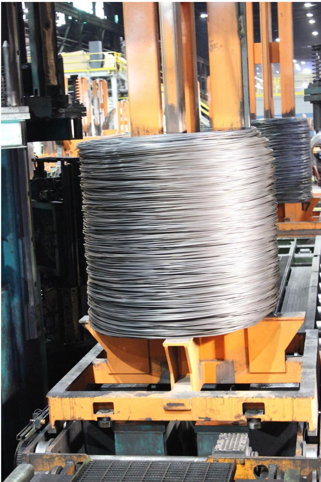
Sistema a pallet per trasporto verticale di Primetals Technologies
