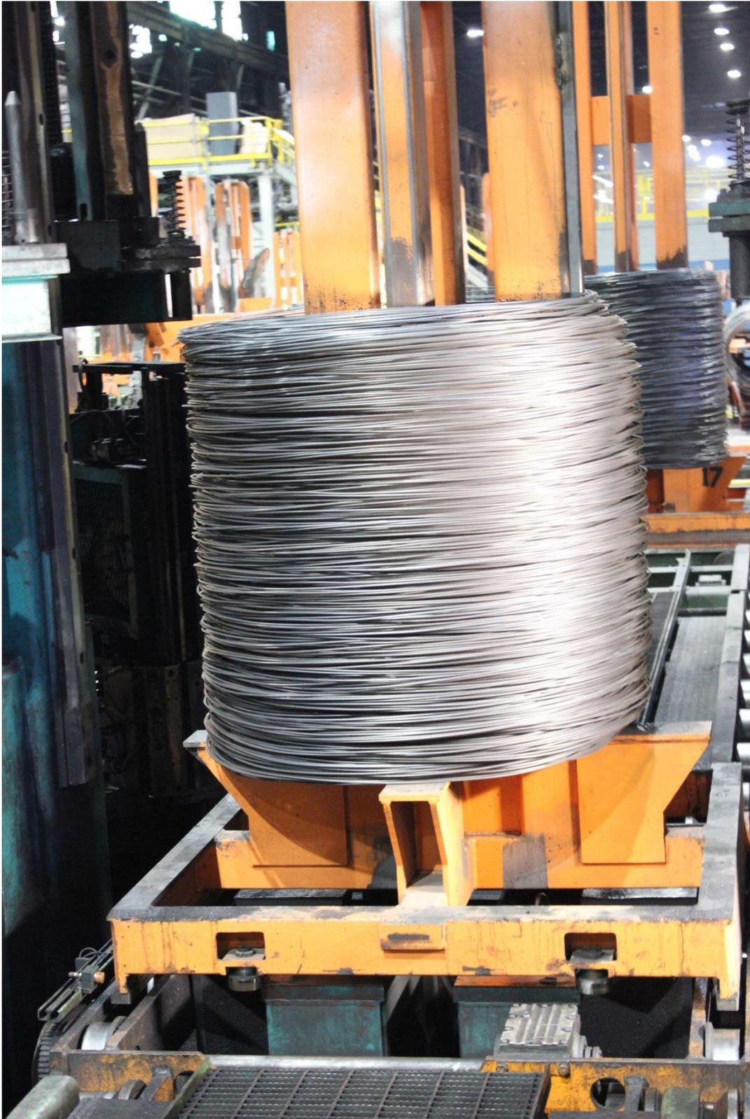
Esteira transportadora de haste vertical da Primetals Technologies
