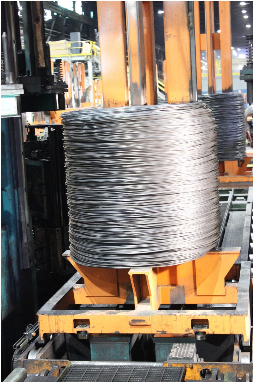
Транспортно-загрузочная система бунтов от компании Primetals Technologies
