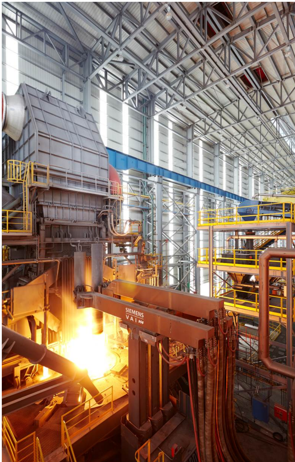
普锐特冶金技术为Tyasa位于墨西哥Ixtaczoquitlan短流程钢厂提供的Quantum 电弧炉
