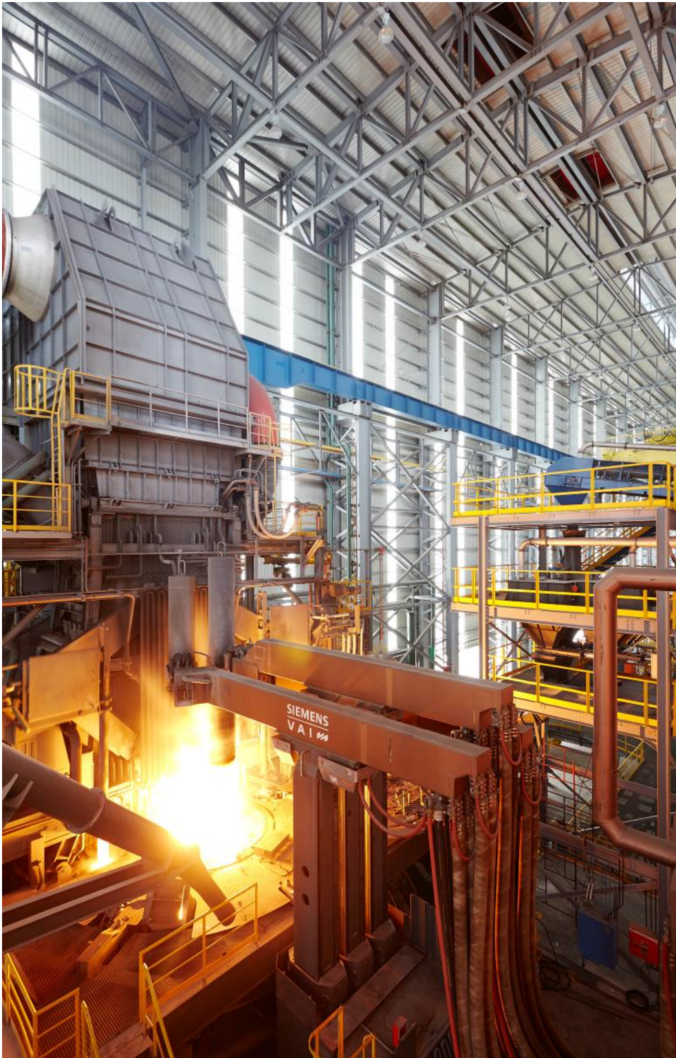
Quantum EAF von Primetals Technologies im Kompaktstahlwerk von Tyasa in Ixtaczoquitlan, Mexiko
