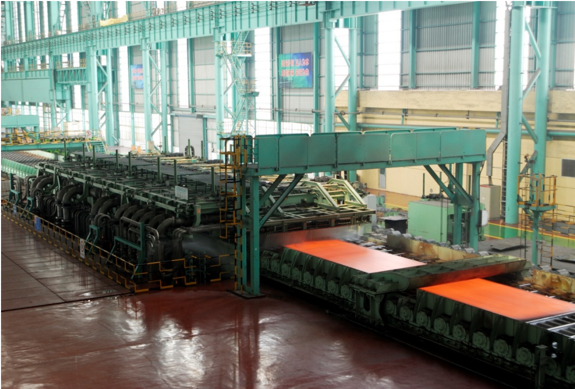
普锐特冶金技术提供的 Mulpic（多功能间断式冷却）系统
