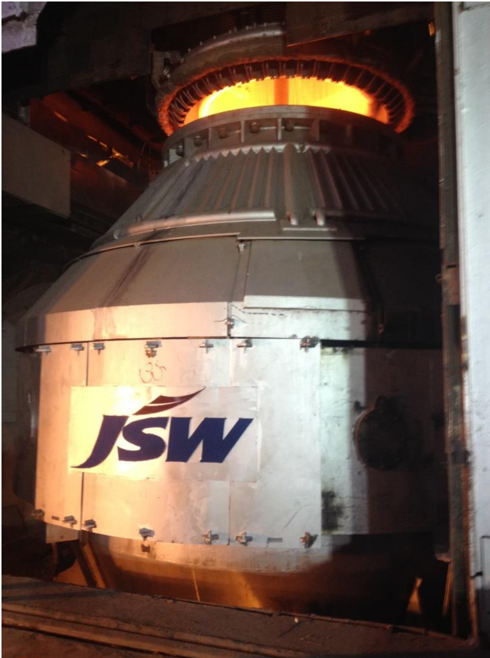
LD(BOF)-Konvertervon Primetals Technologies im Konverterstahlwerk Nr. 2 in Vijayanagar, Toranagallu, Indien von JSW Steel.
