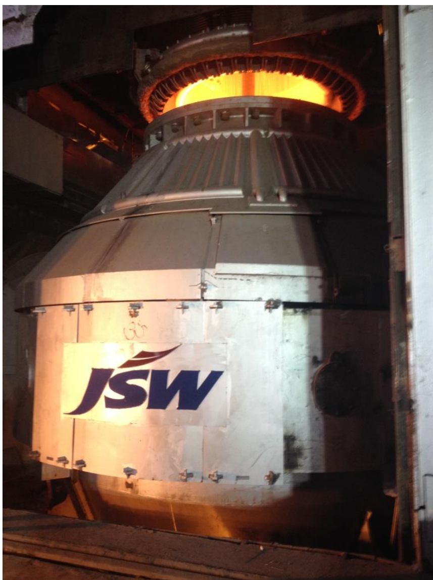
Conversor LD (BOF) da Primetals Technologies na Aciaria nr. 2 na usina Vijayanagar da JSW Steel., em Toranagallu, Índia
