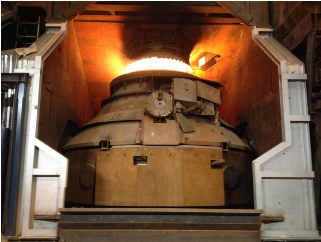
SSAB Europe 社のフィンランド・ラーヘ製鉄所の LD (BOF) 転炉 (Primetals Technologies 提供)
