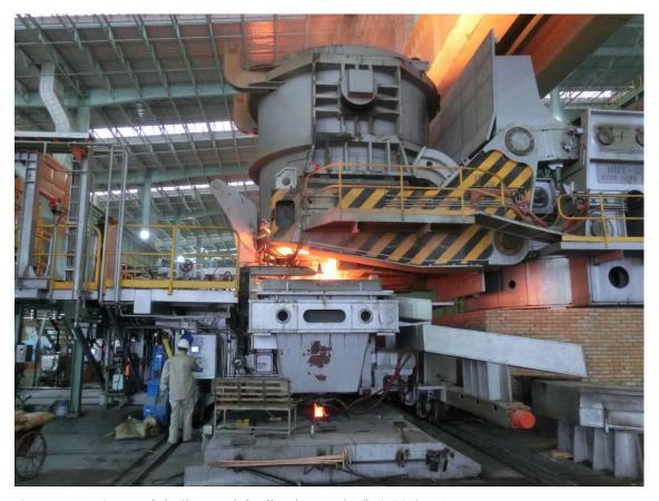
本年9月に中国・宝鋼集団の宝鋼湛江鋼鉄で操業を開始した Primetals Technologies 納入の2ストランド方式・連続スラブ鋳造機。
