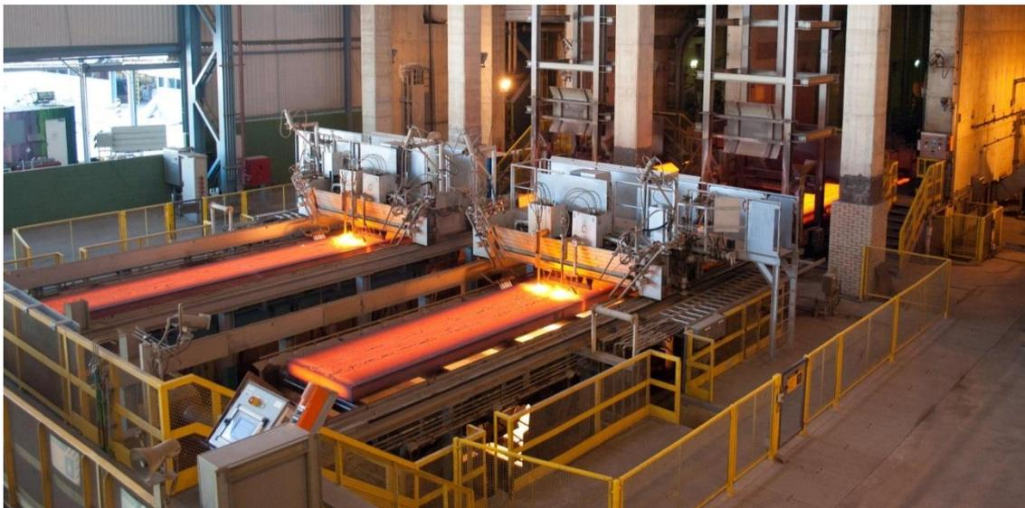
普锐特冶金技术双流板坯连铸机。两台类似连铸机将提供给中国钢铁企业——山东钢铁集团日照有限公司。
