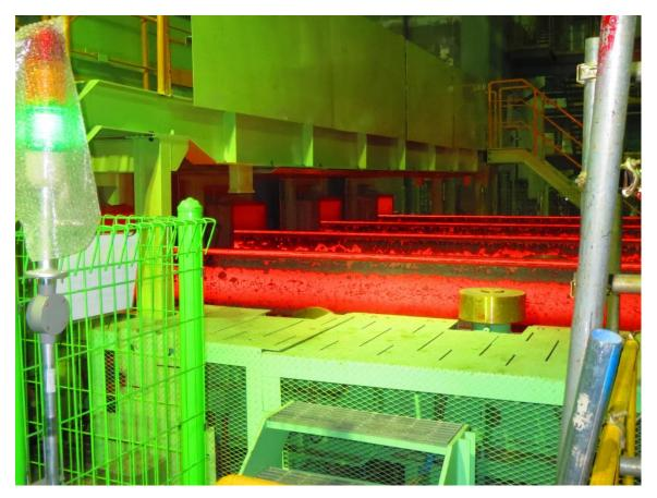
普锐特冶金技术为现代钢铁公司韩国唐津工厂提供的大方坯连铸机
