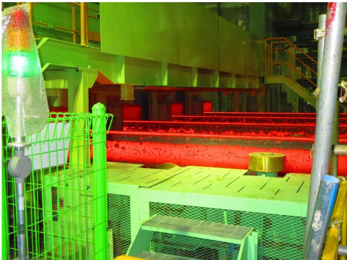
Primetals Technologies が現代製鉄唐津製鉄所に納入したブルーム連続製造機
