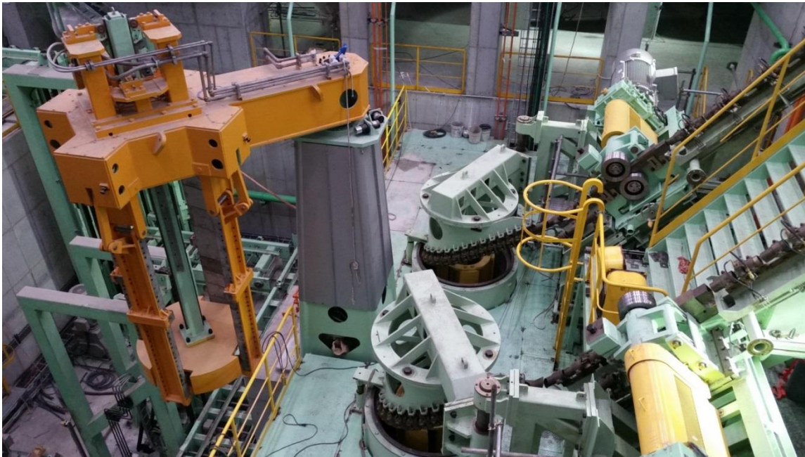
Stazione di bobinatura e trasferimento per bordone di Primetals Technologies
